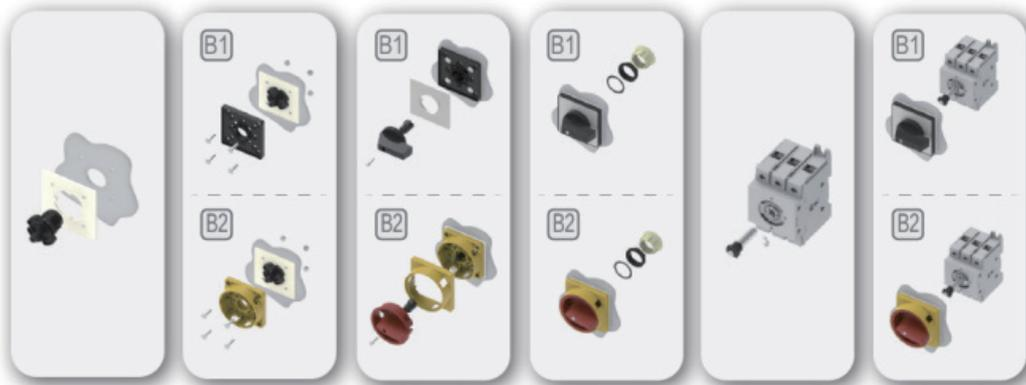
Figure 27 Montaje de mando en puerta
