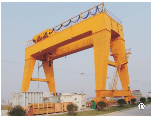
• (C) (D) 200 ton gantry crane
